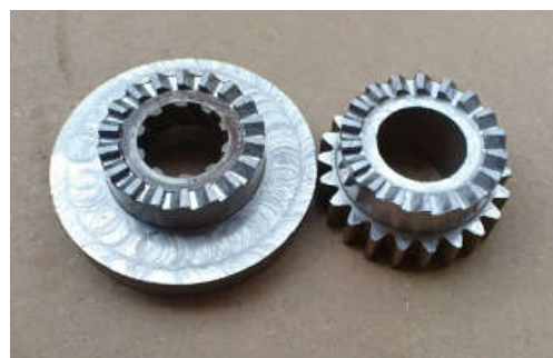
Hình 3. Ly hợp tự động một chiều lắp trên bánh sau của xe tiết kiệm
