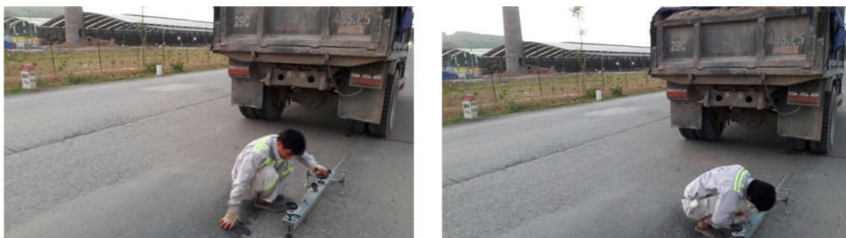
Hình 1. Công tác đo võng bằng BKM tại hiện trường
