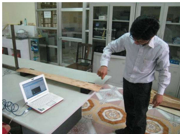
Hình 2. Thí nghiệm xác định modun đàn hồi uốn tĩnh bằng phương pháp không phá hủy mẫu (BING test)
