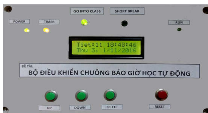
Hình 11. Giao diện bộ điều khiển hoàn chỉnh
